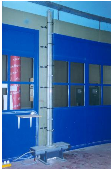
Photo 4.1 : colonne d'étalonnage des capteurs de pression (photo J.-L. Bertrand-Krajewski)
