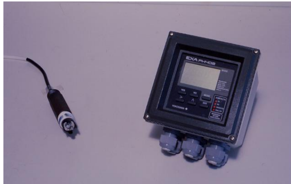
Photo 4.2 : capteur et transmetteur du pH-mètre Yokogawa FU 20 dont l'étalonnage est décrit dans le texte (photo Service Audiovisuel INSA de Lyon)
